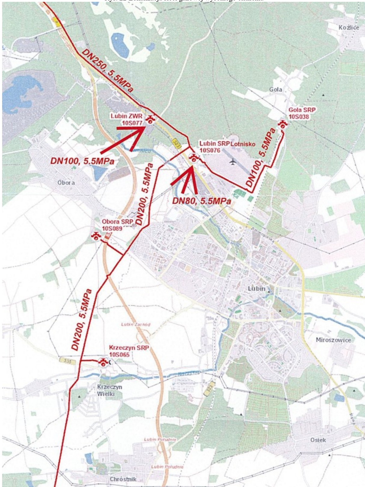
Rys. 22 Lokalizacja sieci gazowej wysokiego ciśnienia
